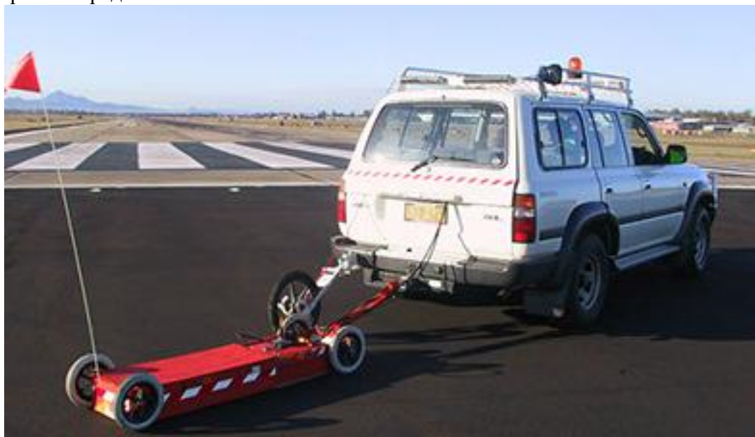
Рис. 2 Георадар в составе дорожной лаборатории
