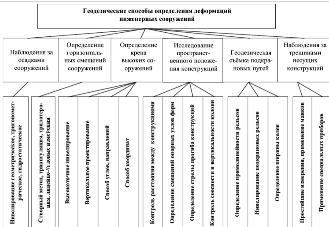
Рис. 2 Классификация способов определения деформаций инженерных сооружений.
