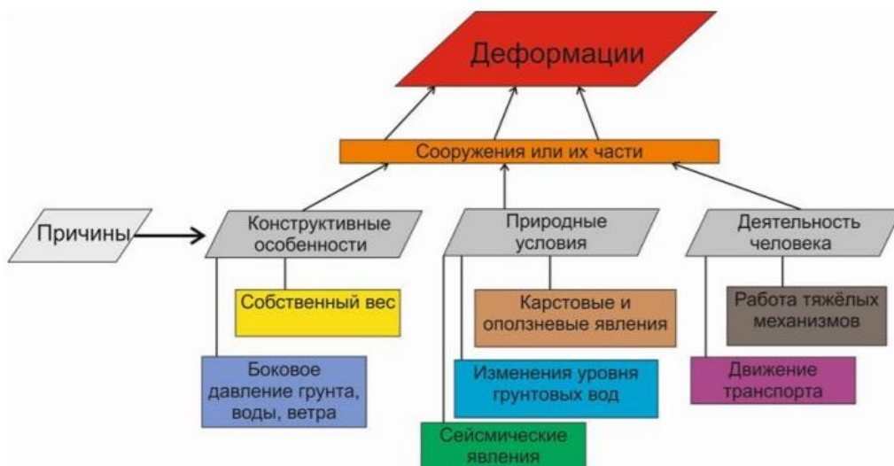
Рис. 1 – Причины деформаций сооружений
