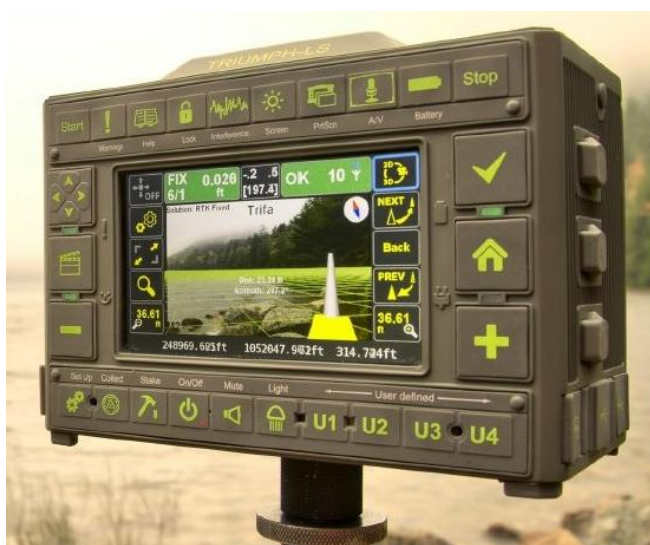
Рис.3 GNSS JAVAD TRIUMPH LS
